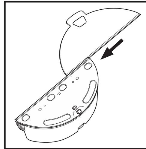
Placez le tampon en insérant le bord plat dans la fente du réservoir. Tirez-le tout le long de la fente jusqu'à ce qu'il soit complètement inséré.
