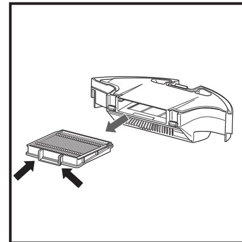
Tirez le filtre par les languettes pour le sortir du réservoir à poussière.
