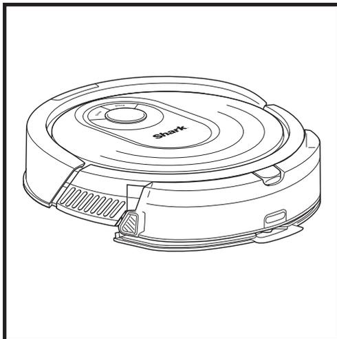
Lorsque le réservoir est rempli et bien installé et que le tampon est fixé, le robot est prêt à aspirer et laver simultanément. Appuyez sur le bouton CLEAN sur le robot ou dans l'application pour lancer un cycle d'aspiration et de lavage. Le robot va préparer le tampon pendant 30 secondes avant de démarrer son cycle.
