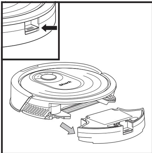
Lorsque le réservoir à liquide est retiré, appuyez sur le **bouton de déverrouillage du réservoir à poussière** et faites-le glisser.
