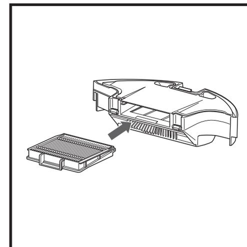
Réinsérez le filtre dans le réservoir à poussière, puis faites glisser le réservoir dans son emplacement jusqu'à entendre un déclic.
