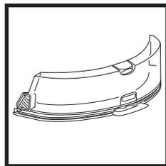
Videz le réservoir après chaque utilisation. Rincez le réservoir et laissez-le sécher à l'air. Ne mettez PAS le réservoir au lave-vaisselle.
