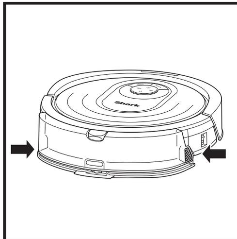
Lorsque le lavage est terminé, retirez le réservoir en appuyant sur les deux boutons et en le faisant glisser. Videz le réservoir après chaque utilisation.
