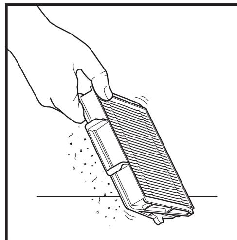
Tapotez légèrement le filtre pour éliminer les débris à chaque fois que vous videz le réservoir à poussière. Pour un nettoyage approfondi, rincez le filtre à l'eau une fois par mois. Laissez sécher le filtre à l'air libre pendant au moins 24 heures avant de le réinstaller. N'utilisez pas de savon et ne frottez pas le filtre. Cela risquerait d'endommager le matériau.
