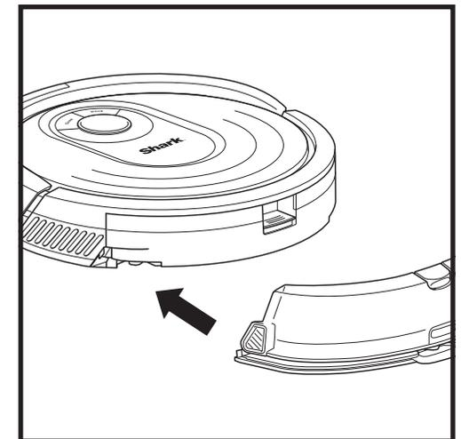
Poussez fermement le réservoir à l'arrière du robot, derrière le réservoir à poussière, et assurez-vous que les deux loquets se mettent bien en place en émettant un déclic. L'indicateur lumineux en forme de goutte d'eau sur le robot s'éclaire en blanc lorsque le réservoir est bien inséré.
