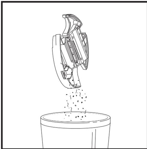
Videz les débris et la poussière dans la poubelle. Nettoyez le réservoir à l'eau si nécessaire.
