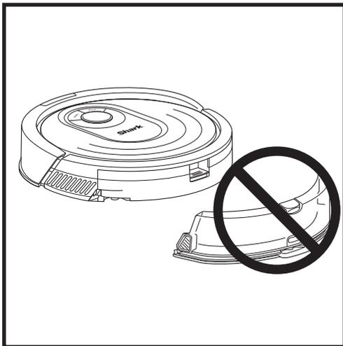
Lors de l'aspiration, le réservoir à liquide ne doit **PAS** être fixé au robot. Assurez-vous que le réservoir à poussière est bien installé.
