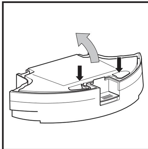
Pour ouvrir le couvercle du réservoir à poussière, appuyez sur le bouton tout en soulevant le couvercle à l'aide des fentes prévues à cet effet.
