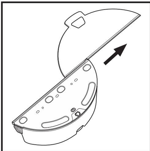
Pour retirer le tampon du réservoir, détachez-le de l'arrière du réservoir et faites-le glisser hors de la fente.
