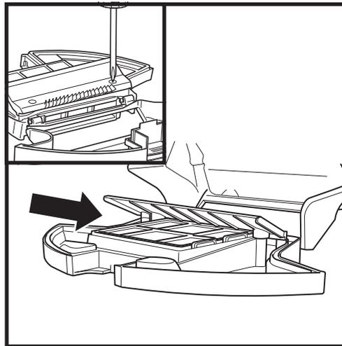
Pour éviter la moisissure, nettoyez la zone entre le filtre et la protection plastique après chaque cycle de lavage, et régulièrement après l'aspiration. Retirez la protection et éliminez tout dépôt de débris avec un chiffon sec ou une brosse souple.
