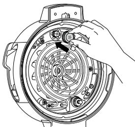
**REMARQUE :** Avant chaque utilisation, assurez-vous que le joint en silicone est bien en place sur son support, et que le bouchon anti-obstruction est correctement placé sur la soupape de décompression.
