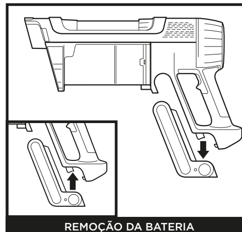
REMOÇÃO DA BATERIA
