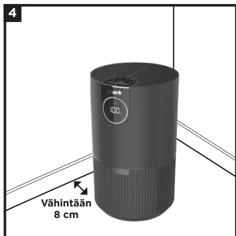
4. Aseta laite tasaiselle pinnalle vähintään 8 cm:n etäisyydelle seinistä ja esineistä.
