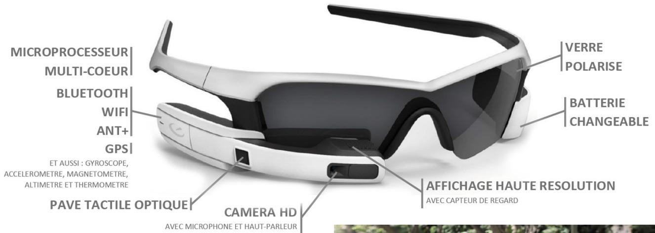
LE RECON JET EST À PREMIÈRE VUE UNE PAIRE DE LUNETTES. MAIS EN Y REGARDANT DE PLUS PRÈS, VOUS DÉCOUVRIREZ UN MICRO-ORDINATEUR AUTONOME TRÈS PUISSANT ÉQUIPÉ D'UN PROCESSEUR DE TRAITEMENT DE L'INFORMATION, DE 9 CAPTEURS SENSITIFS ET D'UNE CAPACITÉ DE CONNEXION RÉSEAU QUE VOUS POURRIEZ ATTENDRE D'UNE TABLETTE OU D'UN SMARTPHONE.
