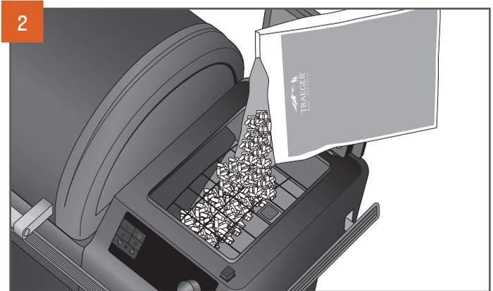
Ouvrez le couvercle de la trémie. Assurez-vous qu'il n'y a pas de corps étrangers dans la tarière avant d'ajouter les granules dans le réservoir à granules de bois. Après avoir ajouté les granules dans la trémie, fermez le couvercle de la trémie. Nous vous recommandons de remplir la trémie de granules au moins jusqu'à la grille de sécurité de la trémie.
