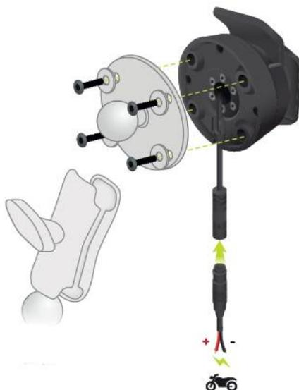
**Important :** le câble rouge POS (+) doit être relié au système de câblage de la moto en un point situé entre le contact et l'alimentation +12 V de la batterie. Le câble noir NEG (-) doit être relié au système de câblage de la moto en un point situé entre le contact et l'alimentation - (GND) de la batterie. Le point 12 V choisi doit être situé sur un circuit qui se désactive lorsque vous coupez le contact, comme celui des feux.
