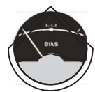
Schéma 4 Biais-mètre hors service
