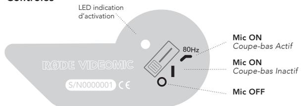
Le filtre coupe-bas (HPF) est un réglage de coupure des basses fréquences, que vous pouvez utiliser pour supprimer le grondement, le bruit de la caméra ou tout autre bruit à basse fréquence pendant l'enregistrement.
