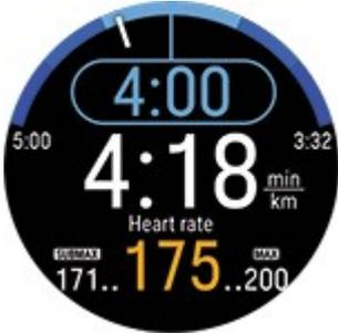
En bas, vous pouvez voir votre fréquence cardiaque actuelle, la fréquence cardiaque minimale requise pour le test sous-maximal et votre fréquence cardiaque maximale actuelle.
