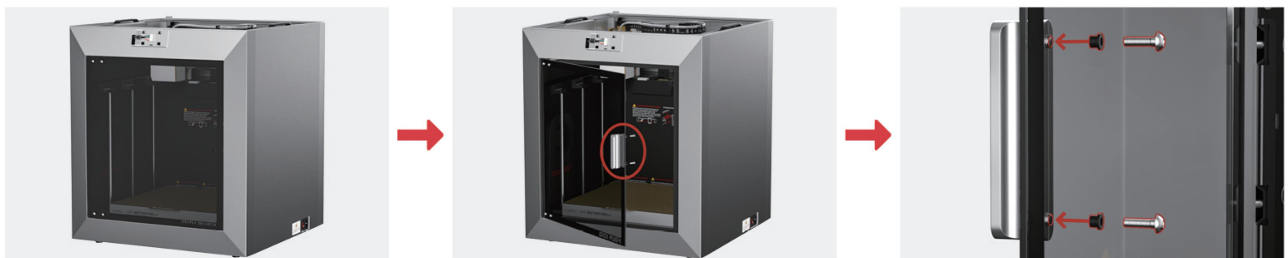
3. Sortez l'écran de la boîte d'accessoires au fond du carton, connectez-le avec le câble de l'écran sur la machine, et fixez le câble dans la fente correspondant à l'écran.
