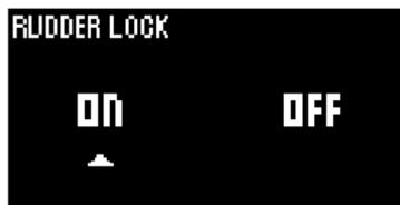
Le blocage de la gouverne de direction permet d'empêcher les actions provenant des rotations du manche. Cette option peut par exemple servir lorsqu'aucun contrôle de mouvement de lacet n'est requis ou lorsque le manche est utilisé conjointement à un palonnier.
