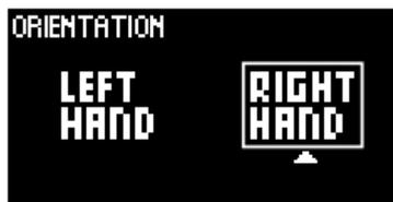
Par défaut, le produit est configuré pour les droitiers. Lorsque le produit est configuré pour les gauchers, l'assignation des boutons et axes des contrôles de base s'inverse. Vous pouvez donc utiliser le manche avec votre main gauche, tout en disposant toujours d'un accès facile aux contrôles ABXY et aux commandes des manettes de gaz primaires avec votre main droite. Vous évitez ainsi les mouvements de mains inconfortables et les réglages de profil chronophages.
