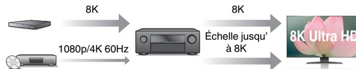
Cet appareil est équipé d'une fonction de vidéo ascendante 8K qui permet de reproduire une vidéo 1080p/4K en résolution HDMI à 8K (7680 × 4320 pixels). Cette fonction permet à l'appareil d'être connecté à un téléviseur à l'aide d'un simple câble HDMI, et de produire des images en haute définition pour n'importe quelle source vidéo.
