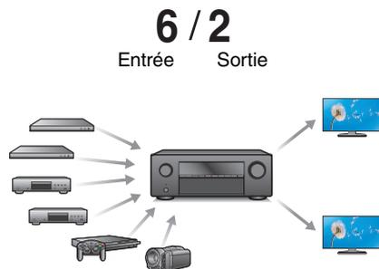
Cet appareil est équipé de 6 entrées HDMI et de 2 sorties HDMI permettant la connexion à divers appareils compatibles HDMI tels que des lecteurs Blu-ray Disc, des consoles de jeux et des caméscopes vidéo HD. Cet appareil est équipé de deux sorties moniteur, ce qui vous permet de projeter la même image en même temps à l'aide de cet appareil.
