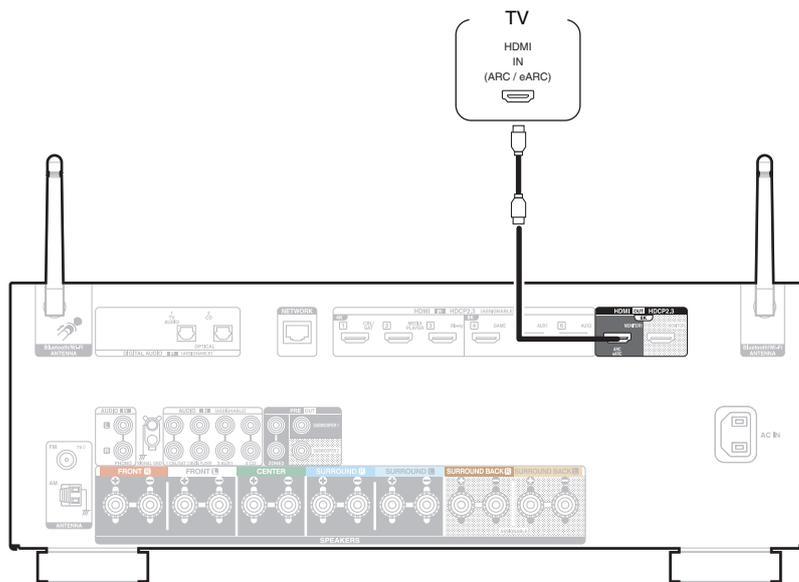
\* Pour les téléviseurs 4K, nous recommandons d'utiliser un câble HDMI étiqueté "High Speed" et "with Ethernet".
