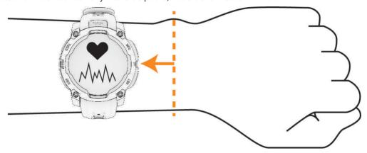
**REMARQUE**: le capteur optique est situé à l'arrière de la montre.
