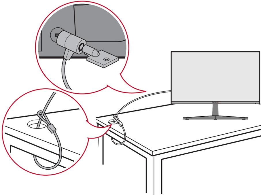
Pour éviter le vol de l'appareil, utilisez un dispositif de verrouillage pour fente de sécurité afin de le solidariser avec un objet fixe.
