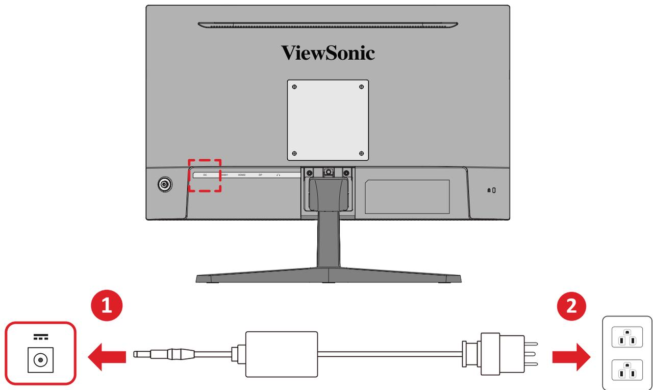
1. Branchez l'adaptateur d'alimentation sur la prise ENTRÉE CC située à l'arrière de l'appareil.
