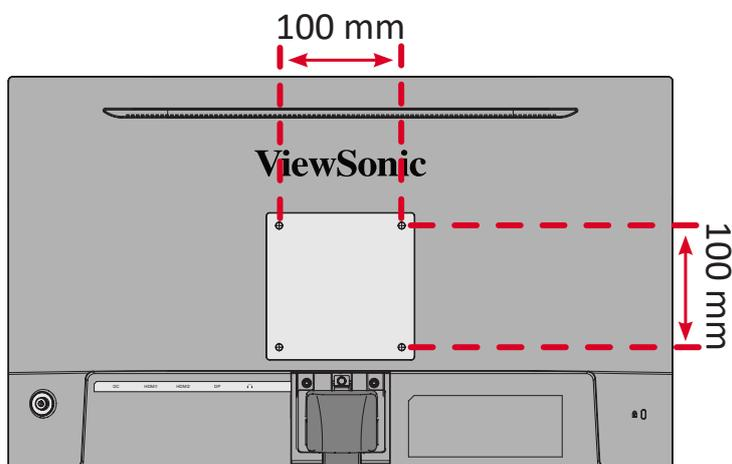
1. Fixez le support de montage aux trous de montage VESA au dos de l'appareil. Puis fixez-le avec quatre (4) vis (M4 x 10 mm).
