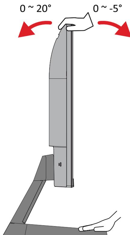
**REMARQUE :** Lors du réglage, tenez fermement le support avec une main tout en inclinant le moniteur vers l'avant ou l'arrière avec l'autre main.
