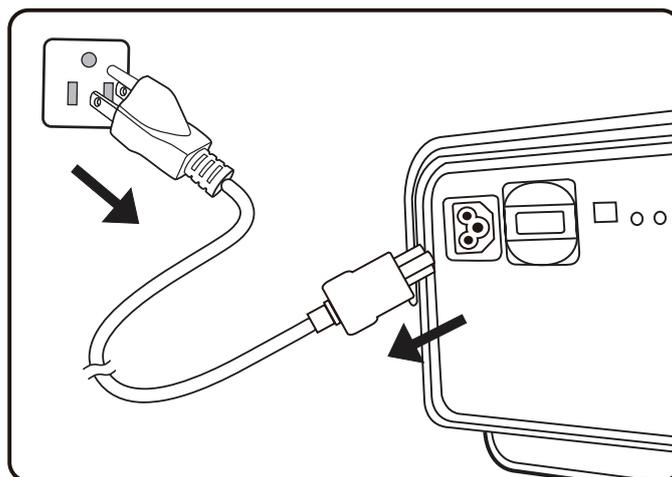
**REMARQUE :** Lors de l'installation du projecteur, intégrez un dispositif de déconnexion facilement accessible dans le câblage fixe ou branchez la fiche d'alimentation à une prise électrique facilement accessible à proximité de l'appareil. En cas de panne pendant l'utilisation du projecteur, utilisez le dispositif de déconnexion pour couper l'alimentation électrique ou débranchez la fiche d'alimentation.
