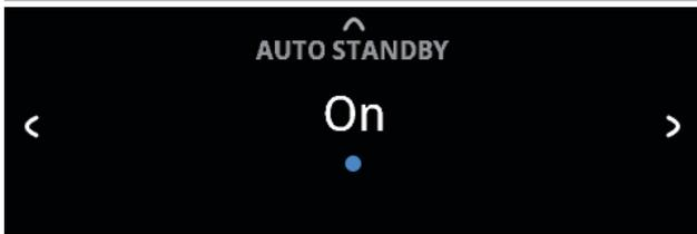
La fonction de Veille automatique est une caractéristique intégrale du C 658 conforme aux réglementations de conception écologique européennes. Le C 658 peut être réglé pour passer automatiquement au mode Veille s'il n'y a pas d'interaction de l'interface utilisateur et qu'aucune source d'entrée n'est active pendant 20 minutes.
