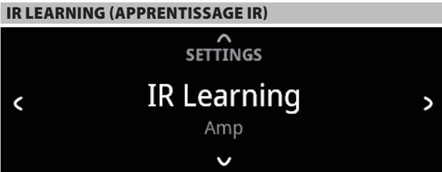
Cette fonction permet à toute télécommande de marque autre que NAD d'apprendre les codes de commande AMP et BluOS de base. Grâce aux codes appris, la télécommande de marque autre que NAD peut alors être utilisée pour commander le C 658.
