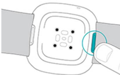
2. Pour déverrouiller l'attache, appuyez sur le bouton plat situé sur le bracelet.
