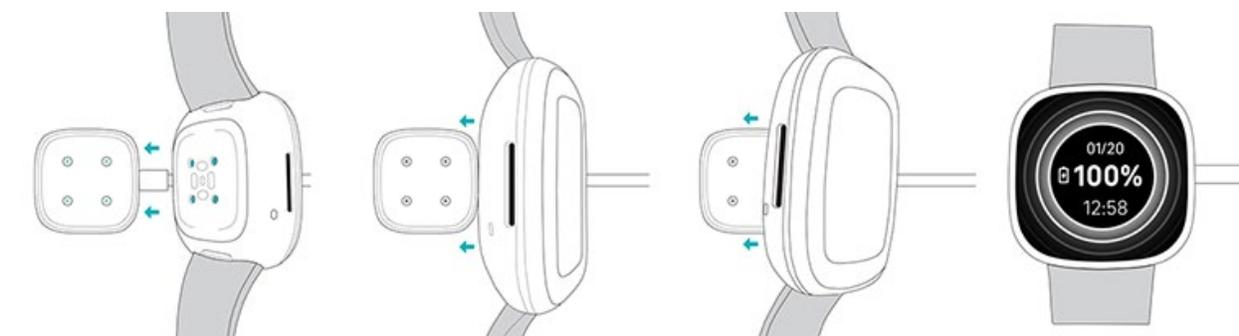
Chargez Versa 3 pendant 12 minutes pour 24 heures d'autonomie de batterie. Pendant que la montre charge, tapotez sur l'écran deux fois ou appuyez sur n'importe quel bouton pour allumer l'écran. Le niveau de la batterie s'affiche pendant quelques secondes, puis disparaît pour que vous puissiez utiliser votre montre pendant la charge. Le chargement complet peut prendre environ 1 à 2 heures.
