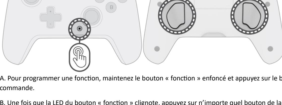
A. Pour programmer une fonction, maintenez le bouton « fonction » enfoncé et appuyez sur le bouton arrière auquel vous souhaitez mapper une commande.
