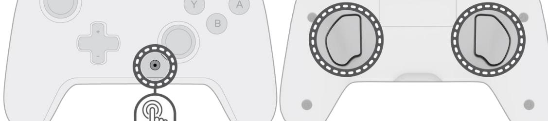
A. Zum Programmieren hältst du die Funktionstaste gedrückt und drückst die hintere Taste, der du ein Steuerelement zuweisen möchtest.
