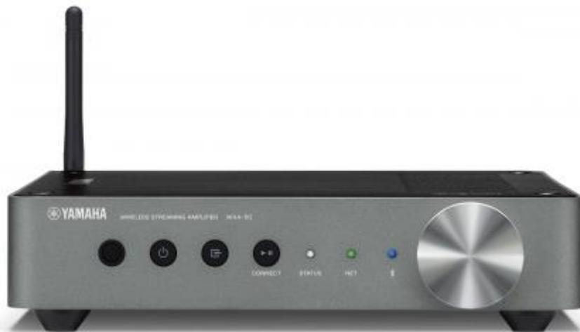
On trouve sur la façade, en partant de la gauche, la fenêtre du récepteur de télécommande, la touche de mise en marche, celle de sélection d'entrée, et celle de lecture/pause, la première permettant, lorsqu'on la maintient appuyée durant cinq secondes de configurer le réseau sans fil en conjugaison avec la touche WPS du routeur LAN, tandis que la seconde, dans les mêmes conditions d'utilisation, donne accès aux réglages réseau au moyen de l'application MusicCast.
