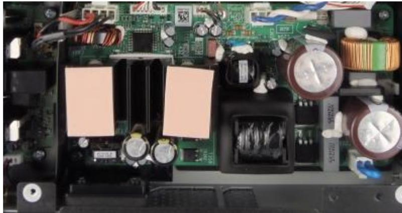
On peut remarquer que les étages d'amplification bénéficient de refroidisseurs munis de pads thermo conducteurs transférant les calories à la plaque de fermeture supérieure, tandis qu'un petit ventilateur peut venir en soutien pour accélérer le refroidissement.
