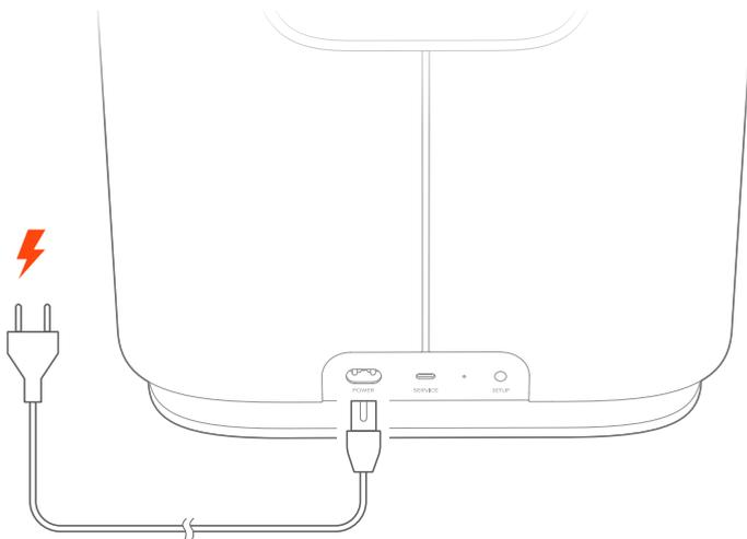
Branchez une extrémité du cordon secteur dans le connecteur **POWER** du panneau arrière, et l'autre extrémité dans une prise secteur.
