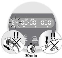
Die elektronische Sicherheitsvorrichtung wird in folgenden Fällen zum Schutz des Motors automatisch ausgelöst: bei bestimmten erschwerten Benutzungsbedingungen
