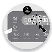
1- Pulse directamente el selector que represente el ajuste que desee configurar, es decir, el selector de velocidad (C3), el de temperatura de cocción (C5) o el de tiempo (C4). El ajuste seleccionado parpadeará en la pantalla.
