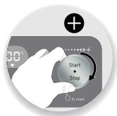
2- Następnie ustawić parametr(y) pokrętkiem wyboru +/- (C14). Ze względu na bezpieczeństwo, nie ma możliwości regulowania temperatury bez ustawienia czasu gotowania.
