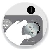
2- При помощи переключателя +/- (C14) настройте значение этого параметра. Из соображений безопасности настроить температуру можно только настроив время приготовления.
