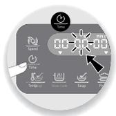
1- Premere direttamente il pulsante corrispondente al parametro da impostare: velocità (C3), temperatura (C5) o durata (C4); il parametro selezionato lampeggerà sul display.
