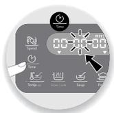
1- Nacisnąć bezpośrednio przycisk wyboru odpowiadający parametrowi, który chcemy ustawić, tzn. przycisk wyboru prędkości (C3) lub przycisk wyboru temperatury gotowania (C5) lub przycisk wyboru czasu (C4); wybrany parametr będzie migał na wyświetlaczu.
