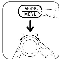
Stel nu het gewicht, het aantal personen of de intensiteit van het bruinen in met de selectietoets. Bevestig uw keuze door of op de knop . Als u dit bevestigd heeft, worden de tijd, de temperatuur en de bereidingsfunctie automatisch bepaald: u heeft de mogelijkheid om handmatig de voorgeprogrammeerde kooktijd te wijzigen. Druk hiervoor op de knop , bepaal uw keuze m.b.v. de knop . Bevestig door nogmaals op de toets te drukken. Druk op . De oven start.
