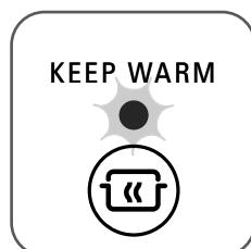
Uw oven beschikt over een functie om aan het eind van de bereiding het eten te blijven verwarmen: uw eten zal automatisch op eettemperatuur blijven, zonder te gaan bereiden. Dit alles tot 10 uur lang. Om de functie automatische warmhoudfunctie te activeren/uit te schakelen, drukt u op de knop . Deze functie kan geactiveerd/uitgeschakeld worden voor of tijdens de bereiding. Het groene lampje gaat branden en geeft aan dat de functie actief is.
