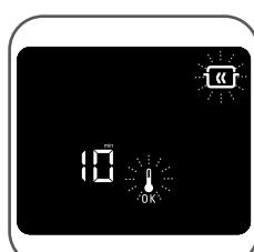
De même le motif se met à clignoter dans l'écran pendant la phase de cuisson et devient fixe pendant la phase de maintien au chaud. Il est possible d'utiliser le mode maintien au chaud sans cuisson préalable (pour réchauffer des assiettes par exemple), dans ce cas appuyez sur la touche **(OK)** quand le four est en veille.
