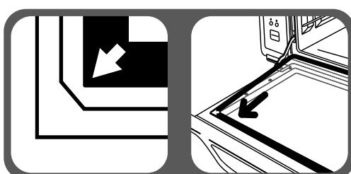
Plaats de binnenruit terug op zijn plaats (markeringen aan de binnenkant van de ovendeur). Let erop om de ruit goed te plaatsen: de **afgeronde hoeken moeten onderaan zijn** (naar het deurscharnier gericht). Plaats de bovenste hoeken het eerst in de gleuven (zie pijlen).
