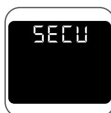
Deze functie is een aanvullende beveiliging om te voorkomen dat kinderen de oven aanraken en/of bedienen. In de stand-by houdt de kinderbeveiliging de oven in stand-by zelfs wanneer de toetsen ingedrukt zijn of de draaiknop gedraaid is. Als de functie geactiveerd is tijdens de bereiding, kunt u geen instellingen wijzigen: om veiligheidsredenen behoudt alleen de toets **STOP** zijn functie om het kookproces te stoppen.
