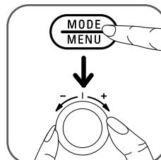
Sie können eine Zubereitungsweise auswählen, indem Sie auf die Taste drücken. Wählen Sie die Zubereitungsdauer mithilfe des Drehknopfs (1e) aus.
