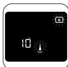
De aanwijzing gaat knipperen op het display tijdens het kookproces en wordt constant gedurende de automatische warmhoudfunctie. Het is mogelijk om de functie warmhoudfunctie zonder voorafgaand kookproces te gebruiken (bijvoorbeeld om borden op te warmen), druk in dit geval op de knop wanneer de oven op stand-by staat.
