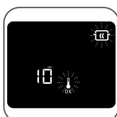
Darüber hinaus fängt das Symbol auf dem Display während der Zubereitungsphase an zu blinken und leuchtet dauerhaft, wenn das Gerät in die Warmhaltephase übergeht.
