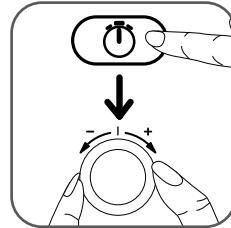
Druk op de knop . Bepaal de kooktijd door de knop te draaien totdat u de gewenste temperatuur bereikt. De digitale display geeft de tijd in uur/minuten weer (b.v.: 0:45).
