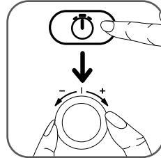
Appuyez sur la touche **START**. Réglez la durée de cuisson en tournant le sélecteur jusqu'à obtention du temps désiré. L'afficheur digital vous indique le temps en heures/minutes (ex. : 0:45).
