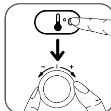
Drücken Sie die Taste . Stellen Sie die Temperatur mithilfe des Wählerschalters ein, bis Sie die gewünschte Temperatur zwischen 80°C und 240°C erreicht haben.
