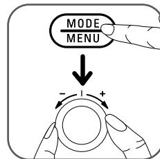
Om de bereidingsfunctie te kiezen, drukt u op de knop . Selecteer de bereidingsfunctie door de draaiknop te draaien (1e).
