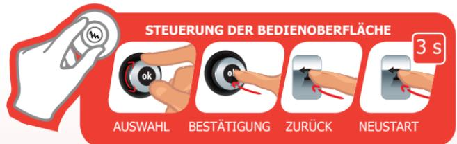
STEUERUNG DER BEDIENOBERFLÄCHE
