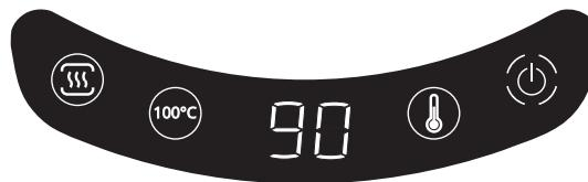
دکمه روشن/خاموش: برای روشن یا خاموش کردن دستگاه
