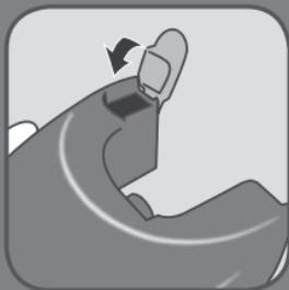
**DE** Schließen Sie die Wassereinfüllöffnung.
