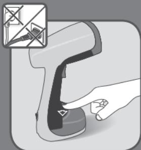
**DE** Betätigen Sie die Wassertankverriegelung.
