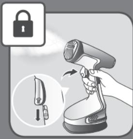
**FR** Pour obtenir un flux de vapeur continu, verrouillez la gâchette de vapeur en plaçant l'interrupteur de verrouillage vers le bas. Pour le relâcher, placez l'interrupteur vers le haut
