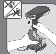
NL Ontgrendel het waterreservoir en verwijder het.
