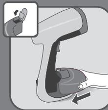
**NL** Sluit de toevoerstop van het waterreservoir. Breng het waterreservoir opnieuw aan op het apparaat en zet het vast.
