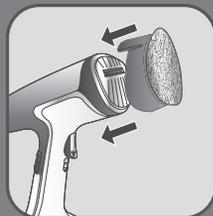
De microvezelborstel\* bestaat uit een steun en een microvezeldoek. Wikkel de microvezeldoek om het kapje, laat stoom vrijkomen en stoom zachtjes met de op- en neerwaartse beweging op het textiel om geïmpregneerd stof te verwijderen. Wanneer de microvezeldoek vuil is, kan deze worden gereinigd. Raadpleeg het gedeelte REINIGING. Gebruik de steun nooit zonder microvezeldoek.
