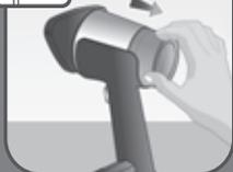
**RU** Снимите резервуар для воды, сдвинув его вниз.
