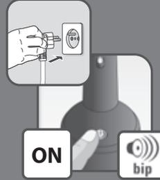
FA دستگاه را به برق بزنید. دستگاه را با فشار دادن دکمه روشن/خاموش روشن کنید. یک سیگنال صوتی روشن شدن آن را تأیید می‌کند.
