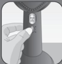
**EL** Για να αλλάξετε τη λειτουργία (ατμός + μαλακή αναρρόφηση ή ατμός + αναρρόφηση turbo), επιλέξτε άλλη λειτουργία στο κουμπί.
