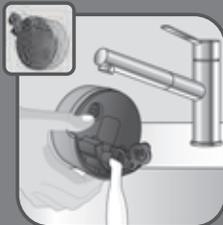
**RU** Полностью опустошите резервуар и закройте крышку отверстия для воды.
