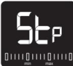
Este icono muestra la palabra "Stop" en un cuadro con una barra horizontal dividida en tres secciones: "min" (izquierda), "max" (derecha) y una sección central que está llena.           | La carga es superior al límite máximo de 160 kg.<br><b>→ No supere la carga máxima.</b>
