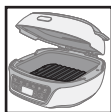
Provjerite je li crni reflektor topline propisno umetnut i pričvršćen na dno uređaja.
