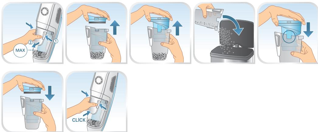
**FR** Pour vider le bac à poussière, appuyez sur les loquets et ôtez-le du corps de l'appareil. Videz le bac et remettez en place les différents éléments : le séparateur puis le couvercle avec son filtre. Réinstallez le bac à poussière sur le corps de l'appareil.
