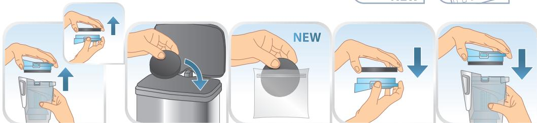
**FR** Remplacez le filtre en mousse du bac à poussière tous les 6 mois. Détachez le couvercle du bac à poussière et retirez le filtre, jetez-le et installez le nouveau filtre.
