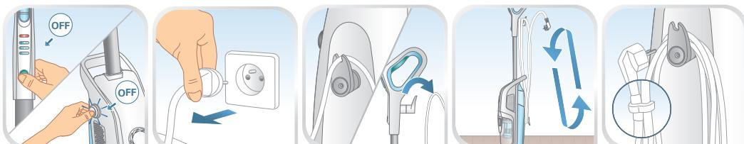
**FR** Éteignez l'appareil après chaque utilisation (appuyez sur les boutons aspiration et On/Off). Débranchez l'appareil et enroulez le cordon.
