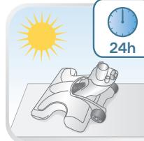
**FR** Pour nettoyer la tête, détachez d'abord le support de lingette, puis la tête du corps de l'appareil. Passez-la sous l'eau et utilisez une éponge si nécessaire. Laissez sécher complètement pendant 24 heures avant de la réinstaller.
