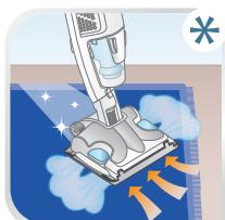
**FR** Pour aspirer et rafraîchir vos tapis avec de la vapeur, utilisez l'accessoire Ultra Glider et choisissez le mode Min. Il est toujours recommandé de tester une zone isolée de la surface à nettoyer avant de continuer. Laissez d'abord sécher la partie vaporisée afin de vous assurer qu'aucun changement de couleur ou déformation ne se produit
