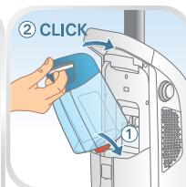
**FR** Remplissez le réservoir d'eau: détachez-le en soulevant la poignée. Dévissez le bouchon et remplissez le réservoir avec de l'eau du robinet. **Attention: ne pas ajouter de produits chimiques, détergents ou parfums.** Revissez le bouchon et replacez le réservoir d'eau sur l'appareil.
