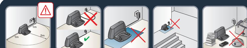
**FR** Pour placer la base de charge, assurez-vous qu'il y a un espace vide de 1 m sur le côté et 2 m en face de la base de charge. N'installez pas la base de charge près d'un escalier. Le câble doit être serré. Placez toujours la station d'accueil sur un sol dur. Ne placez pas la base de charge sur un tapis.
