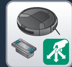
**FR** Attention : Avant d'enlever la batterie, mettez le robot hors tension. Retournez le robot à l'envers pour accéder au compartiment de la batterie. Retirez la batterie en appuyant sur les loquets du compartiment de la batterie et retirez la batterie. Déconnectez la batterie du robot. Recyclez la batterie et le robot.
