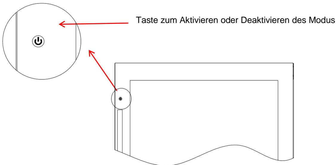
Durch Drücken der Taste wird auch automatisch das Licht im Keller eingeschaltet, um die vorhandenen Flaschen richtig zu erkennen.
