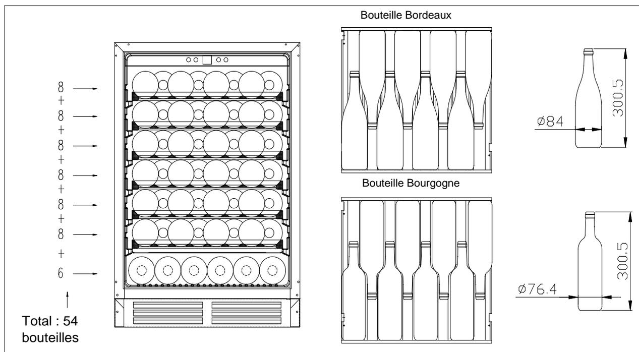
\* Note : dans le cas de l'utilisation du 'bac d'humidification', le nombre maximal de bouteille est diminué
