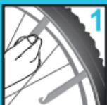
**FR - Démontez le pneu à l'aide des démonte-pneus**
