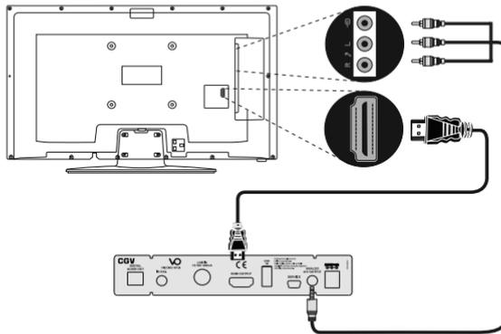
**Connexion HDMI (Recommandée) :** Pour la sortie vidéo HD et audio, vous pouvez utiliser la prise HDMI si votre téléviseur dispose d'une entrée HDMI. Le boîtier décodeur dispose à l'arrière d'une prise HDMI prenant en charge différentes résolutions. Pour une meilleure performance vidéo, veuillez vérifier les résolutions prises en charge par votre téléviseur.
