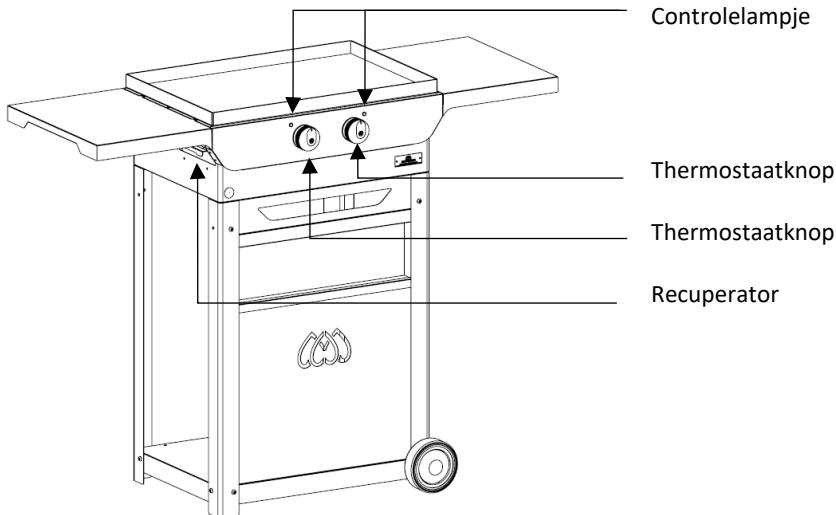
Beschrijving van het apparaat Plancha : PLOE260DP
