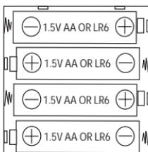
**BELANGRIJKE OPMERKING:** Voor een optimale prestatie wordt het aanbevolen om alkaline batterijen met dit product te gebruiken.
