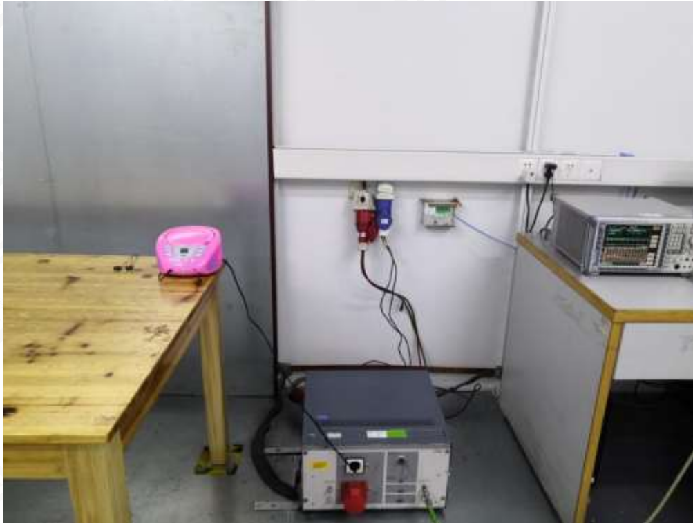
EN 61000-4-2 ESD TEST SETUP
