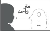
للحصول على جودة صوت جيدة، قم بتوصيل وحدة الطفل بالتيار الكهربائي ووضعه وحدة الطفل على بعد متر واحد على الأقل من رأس الطفل وما يصل إلى ٢,٥ متر من الطفل. يجب أن تظل وحدة الطفل متصلة بالتيار الكهربائي لتعمل لأنها لا تحتوي على بطارية.
