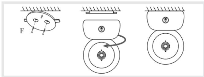
或是使用倾斜附件以便获得更好的角度。摄像头向下倾斜时, 这个凸起的小型底座可让您获得更大的角度。
