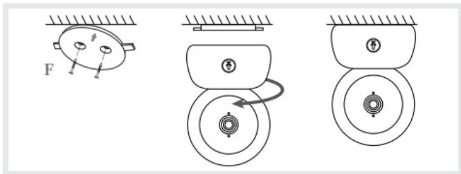
或者使用傾斜配件以獲得更好的角度。在讓攝影機向下傾斜時，此凸起的小型底座可讓您獲得更大的角度。
