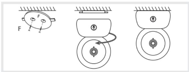
Oder benutzen Sie das Zubehör zum Neigen, um einen besseren Winkel zu haben. Diese kleine, erhöhte Basis wird es Ihnen ermöglichen, einen größeren Winkel zu haben, wenn die Kamera nach unten geneigt ist.
