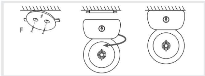
Либо используйте наклонное крепление для получения лучшего угла обзора. Благодаря небольшому приподнятым основанию вы сможете получить более широкий угол обзора, когда камера наклонена вниз. держатель, входящий в комплект поставки.
