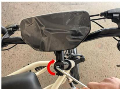
**Étape 6 :** Ajustez le guidon à la position appropriée en vous assurant qu'il est perpendiculaire à la roue avant. Ensuite, fixez le guidon à l'aide de deux boulons M6\*16, puis serrez enfin deux écrous M6.
