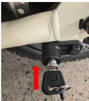
Pour enlever le blocage de votre bloque-disque, il suffit de tourner la clé du bloque-disque dans le sens des aiguilles d'une montre. La serrure va alors se déverrouiller et revenir en position sortie.
