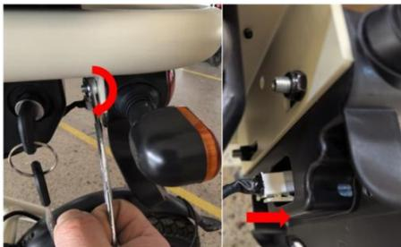
**Étape 8 :** Serrez les écrous des clignotants gauche et droit avec une clé plate (fournie), en veillant à ce qu'ils soient orientés vers l'avant.
