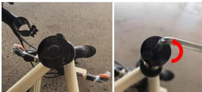
**Étape 5 :** Positionnez le guidon sur la colonne de direction et revissez la partie supérieure de la colonne de direction grâce à la clé hexagonale.
