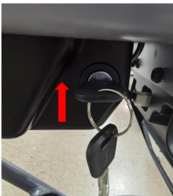
Pour déverrouiller le siège du WIMOB SCOOT, tournez simplement la clé dans le sens des aiguilles d'une montre. Le verrou se débloquera et se soulèvera, vous permettant d'ouvrir le siège.
