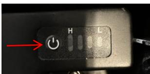
Quand la batterie est complètement chargée, en appuyant sur le bouton de vérification du niveau de charge, on observe ceci :
