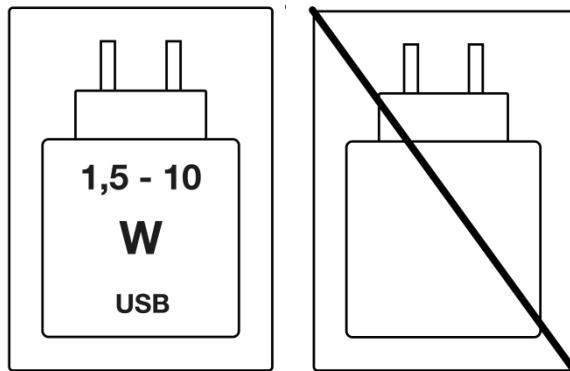
La puissance fournie par le chargeur doit être entre, au minimum 1,5 Watts requis par l'équipement radioélectrique et, au maximum 10 Watts pour atteindre la vitesse de chargement maximale.
