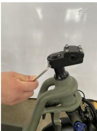
**Etape 6** : Positionnez l'embase du guidon de manière à ce que le passage du guidon soit vers l'avant de votre cyclomobile léger puis revissez les deux vis de fixation de l'embase. Puis revissez la vis dévissée à l'étape 5.
