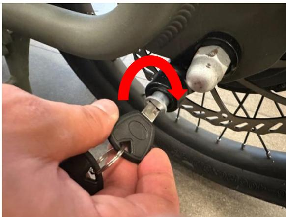
Pour enlever le blocage de votre bloque-disque, il suffit de tourner la clé du bloque-disque dans le sens des aiguilles d'une montre. La serrure va alors se déverrouiller et revenir en position sortie.
