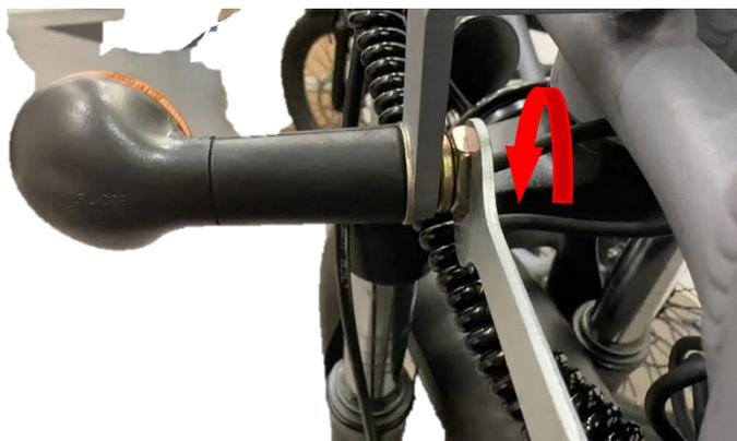
**Etape 13 :** Installez l'ensemble du feu arrière à l'arrière du cadre, vissez les deux écrous à l'aide de la clé plate fournie, connectez la fiche du faisceau.
