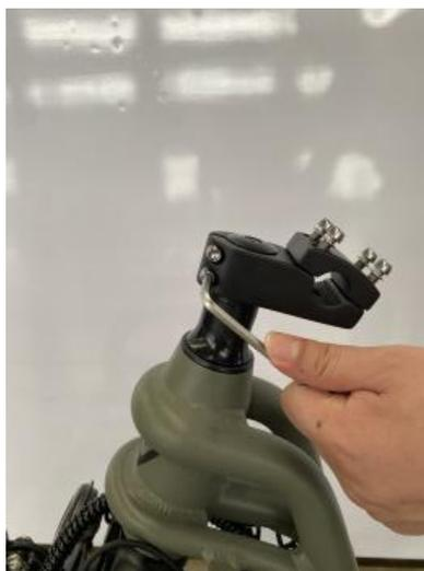
**Etape 4** : Dévissez les deux vis de fixation de l'embase du guidon
