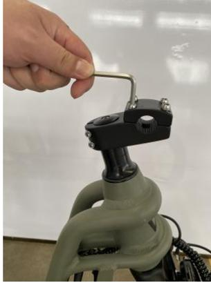
**Etape 7** : Dévissez les quatre vis de maintien de l'embase du guidon puis retirez la moitié supérieure de l'embase
