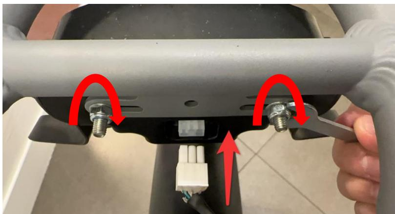
**Etape 14** : Vissez les rétroviseurs de 9 tours, puis une fois en position vissez l'écrou à l'aide de la clé plate.
