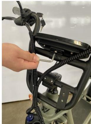
**Etape 10** : Une fois les quatre vis fermement serrées, inclinez l'écran à la position souhaitée et vissez la vis de fixation de l'écran, située à l'arrière de celui-ci.
