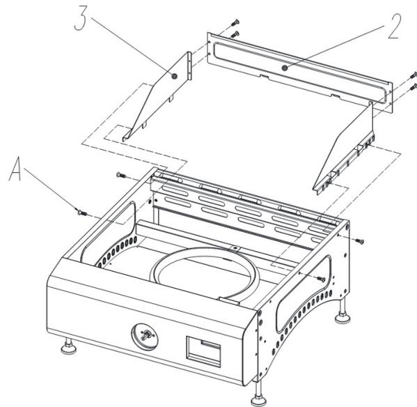
2. Retournez l'appareil sur ses pieds. Insérez les 2 pare-vents latéraux droite et gauche (3) et fixez-les à l'aide de 4 vis (A). Ajoutez ensuite le pare-vent arrière (2) et fixez-le aux pare-vents latéraux à l'aide de 4 vis (A).
