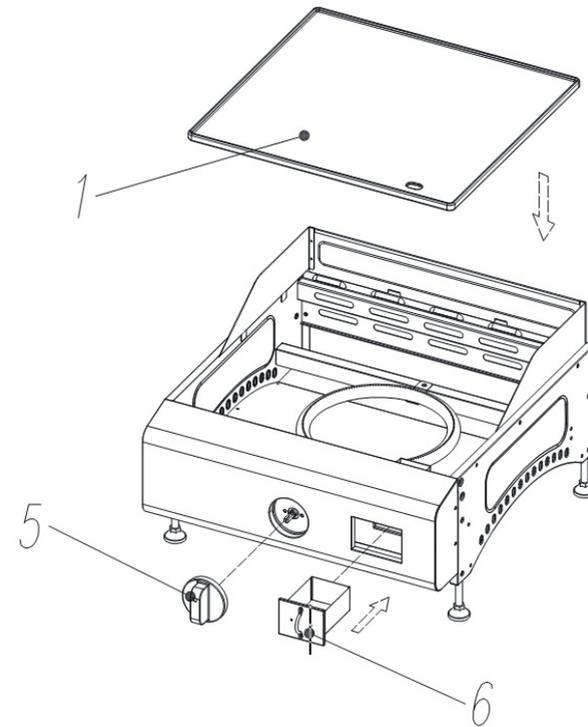
3. Enfoncez la manette de commande (5) à l'avant de l'appareil en veillant à ce que la position « • » (arrêt) soit orientée vers le haut.
