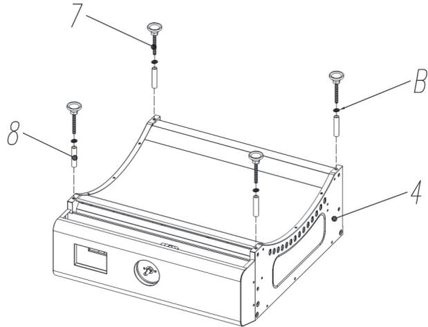
1. Retournez le corps de l'appareil (4) avec précaution et posez-le sur une surface plane et stable, puis assemblez les pieds de l'appareil (7) en les insérant préalablement dans les rondelles (B) et les tubes (8) (schéma ci-dessus). Assurez-vous que les pieds sont solidement fixés à l'appareil.
