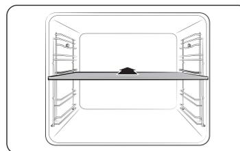
Insérez la plaque séparatrice sur le niveau 3 pour diviser l'enceinte de cuisson en deux compartiments. Le four détecte la plaque séparatrice et active le compartiment supérieur par défaut.
