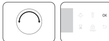
4. Tournez la Molette de sélection de la valeur pour sélectionner une durée de nettoyage parmi 3 niveaux : 1 h 50 min (réglage par défaut), 2 h 10 min et 2 h 30 min.
