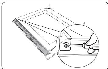
1. Utilisez un tournevis pour retirer les vis sur les côtés gauche et droit.
