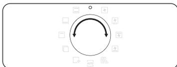
Pendant que la cuisson est en cours, tournez le sélecteur de mode sur « **O** ». Le four s'éteint en quelques secondes. En effet, pour éviter d'accepter de commandes incorrectes de la part des utilisateurs, le four attend quelques secondes pour qu'ils puissent corriger leur sélection.
