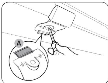
1. Insérez la partie fine (A) du verrouillage mécanique dans l'orifice correspondant de la poignée de verrouillage, comme indiqué.
