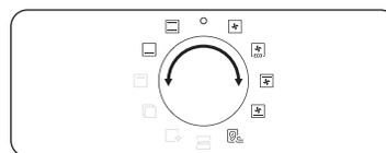
2. Tournez la molette de sélection du mode pour sélectionner un mode de cuisson. Vous pouvez sélectionner le mode Gril, Convection ou Chaleur supérieure + Convection sur le compartiment supérieur, et le mode Convection, Chaleur inférieure + Convection ou Chaleur inférieure sur le compartiment inférieur.
