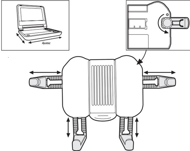
③ Dévissez les boulons pour fixer le bras de maintien sur l'appui-tête.
