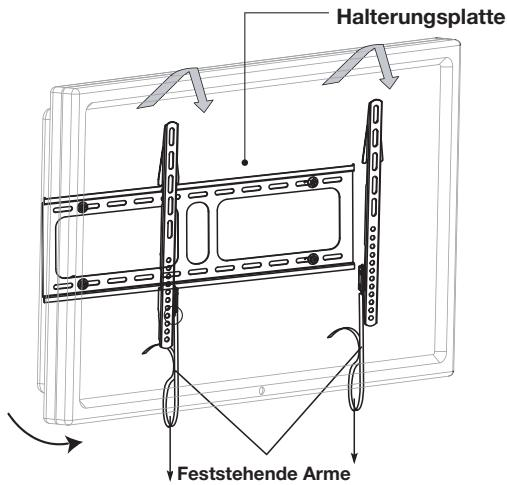
Um den Fernseher wieder aus der Halterung zu entfernen, ziehen Sie einfach an den beiden Laschen in der Verlängerung der Befestigungsarme.
