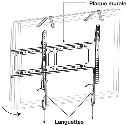
Une fois le téléviseur en place, il est possible de l'ôter de son support, en tirant simplement sur les deux languettes situées dans le prolongement des bras de fixation.
