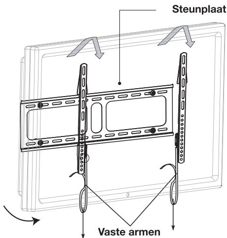
Zodra de televisie op zijn plaats zit, kan deze van de beugel worden verwijderd door aan de twee lipjes in het verlengde van de bevestigingsarmen te trekken.
