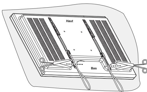
Lorsque le téléviseur est correctement positionné, vous pouvez replier les deux languettes pour former une boucle.
