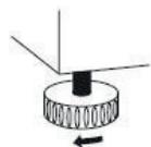
Pour son fonctionnement sans vibration, l'appareil doit être mis à niveau. Pour cela, ajustez les pieds réglables en hauteur afin d'équilibrer correctement l'appareil.
